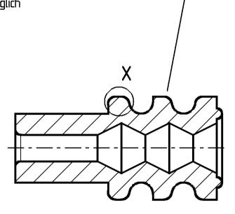
parting line / injection point possible Werkzeugtrennung / Anspritzung moeglich
